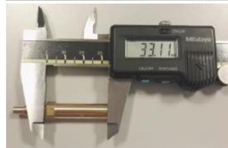
Largo de la sección inferior:  $33,0 \pm 0,45 \text{ mm}$ .
