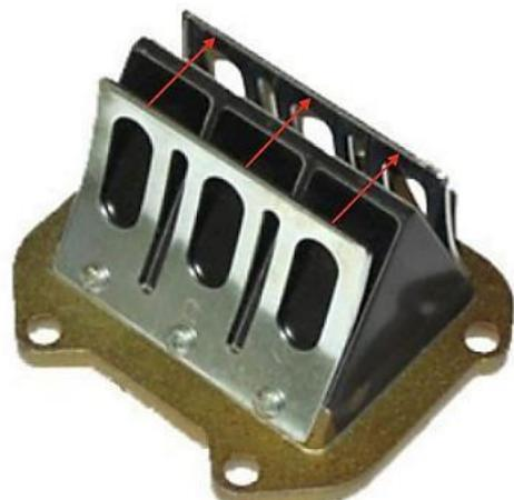
La medición debe realizarse con un calibrador digital desde la superficie interior de las placas en línea con el centro de cada pétalo, como lo indican las líneas rojas de la imagen.
