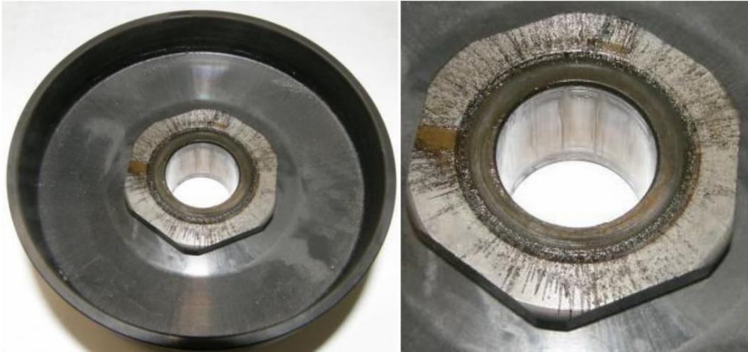
La imagen muestra el peor de los casos de engrase cuando sale de la zona de apoyo, incluso si el O -Ring está instalado. Sólo la tuerca de fijación, así como dentro de la campana, pueden mostrar signos de grasa, la superficie del embrague de marcha debe estar completamente seco.
