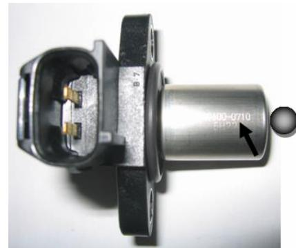
Nota: No es necesario instalar ninguna junta adicional a excepción del anillo de sellado de goma en los cárteres con la superficie de sellado maquinada para el sensor de captación.
